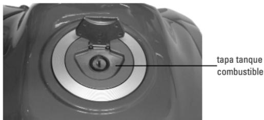
**NOTA:** No llene excesivamente el tanque. Nunca salpique combustible en el motor caliente. Nunca llene el tanque hasta la parte superior del conducto de llenado, porque el tanque puede desbordarse cuando la temperatura de combustible se eleve y se expanda, siendo muy peligroso.
