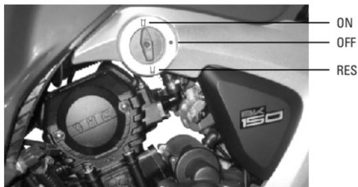
El grifo del combustible se encuentra en la parte inferior izquierda del tanque de combustible.
